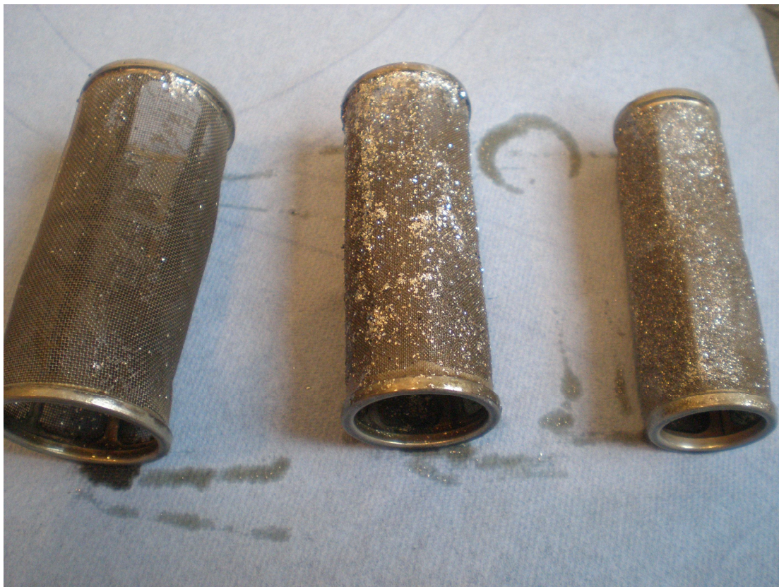
Obr. 2 – Třísky z Al slitiny na sítích hlavního olejového filtru původem z pístu.
