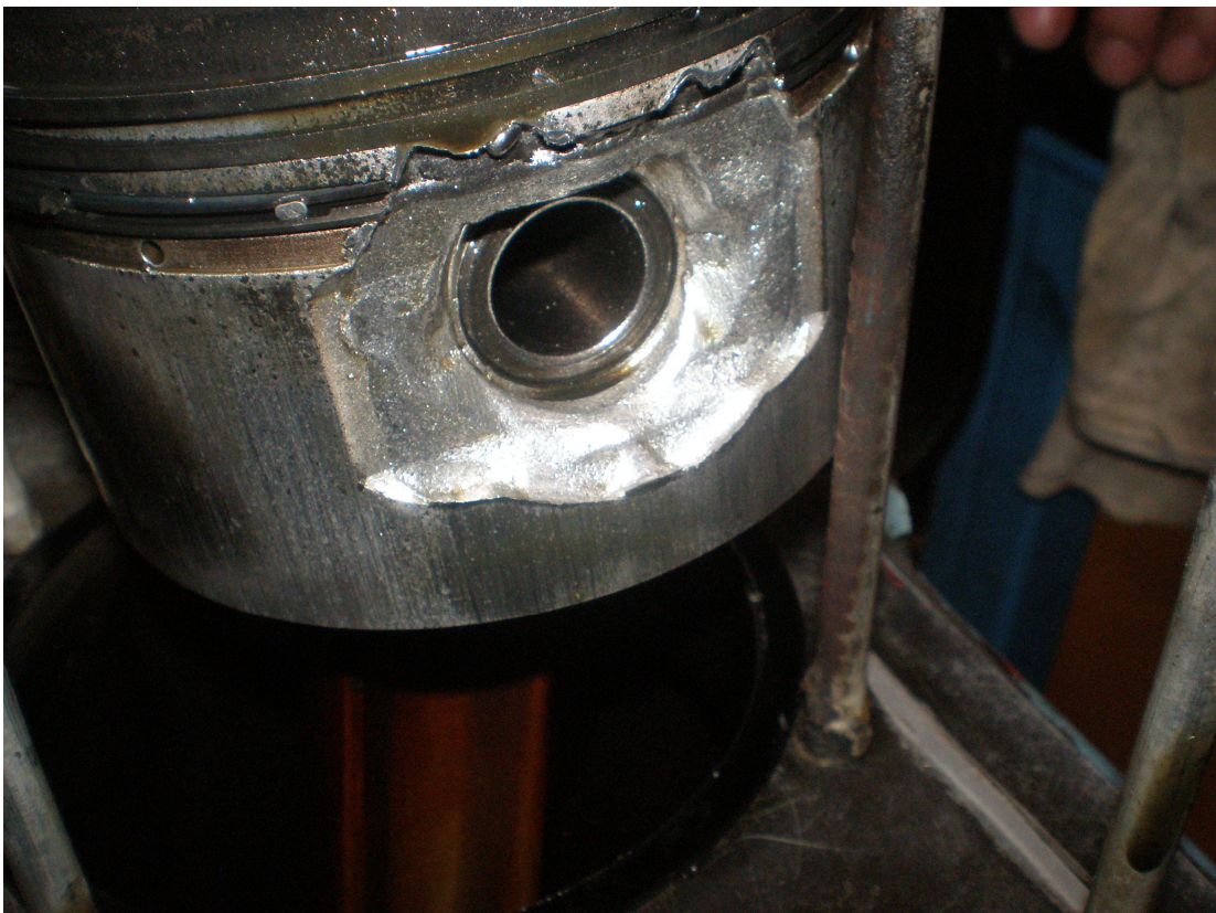
Obr. 1 – Píst poškozený vypadlou pojistkou pístního čepu p/n Sc2515.
