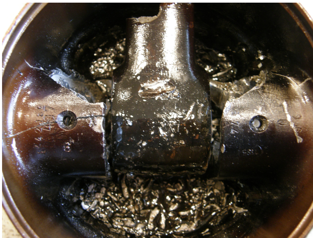
Obr. 3 – Únavový lom pístu.
