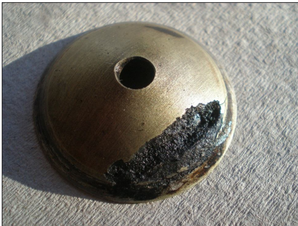
Obr. 8 – Zátka ze 6. ojničního čepu, pohled 2. Významné zeslabení vnitřní stěny zátek korozí.
