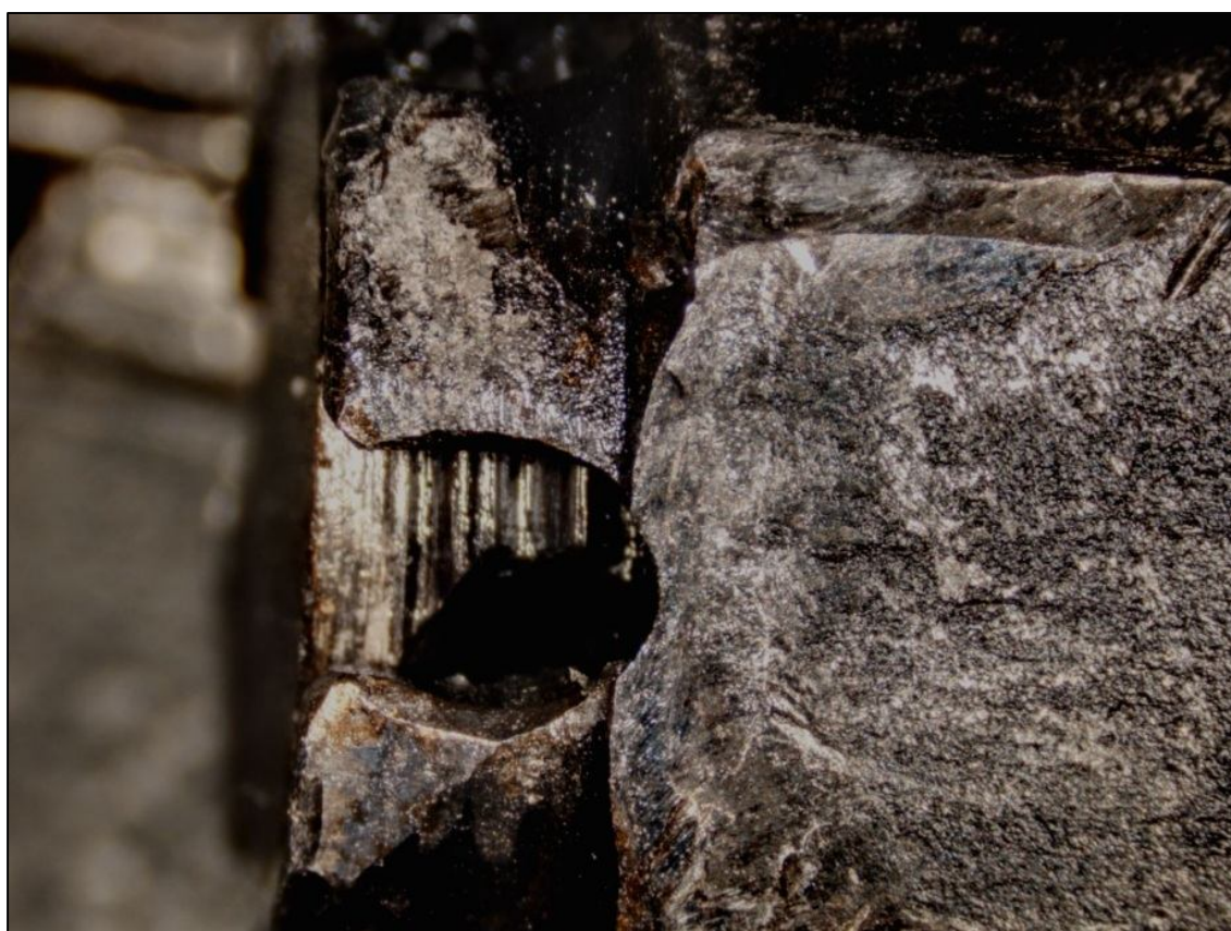
Obr. 4 – Matice šroubu ojnice č. 6 je pootočena a není pojištěna závlačkou.
