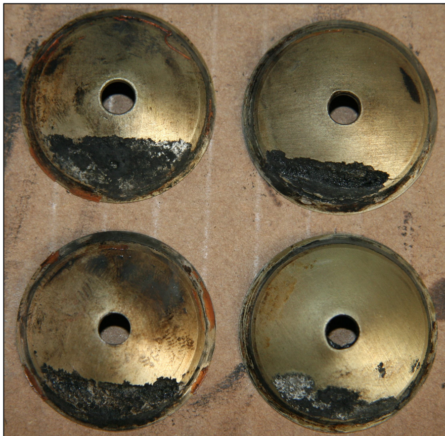
Obr. 6 – Koroze zátek ojních čepů klikového hřídele, nahore z čepu 6, dolní z čepu 1 (referenční).
