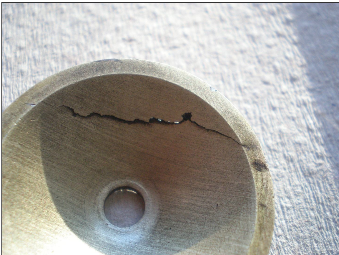
Obr. 9 – Trhlina v místě zeslabení korozí na vnější straně zátky (opačná strana).
