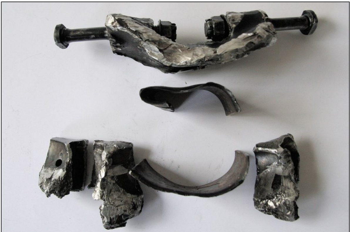
Obr. 2 – Fragmenty hlavy ojnice č.6 a zdeformovaná pánev.
