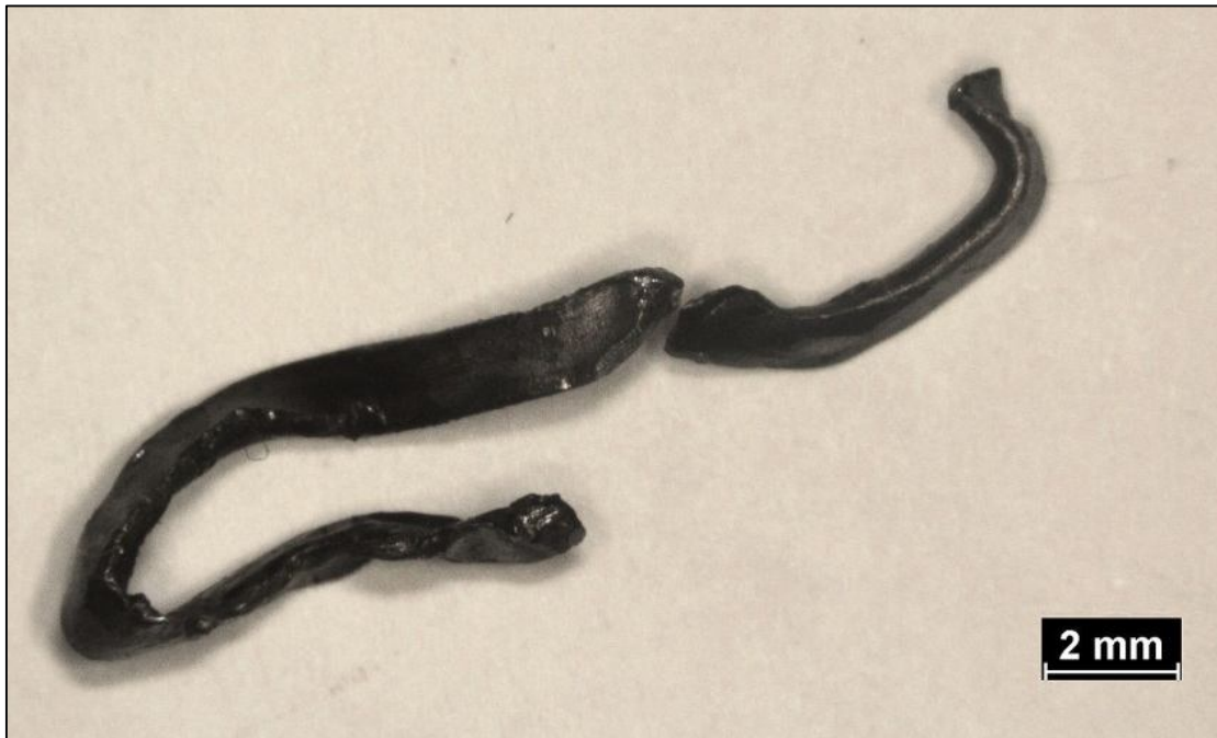
Obr. 5 – Nalezené úlomky závlaček šroubů 6. ojnice.
