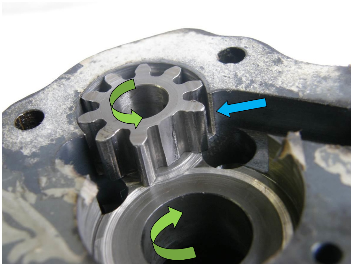
Obr. 2 – Vratné olejové čerpadlo vačkové skříně M137AZ s opotřebenými zuby a obroušenou hranou komory, zelené šipky značí směr otáčení ozubených kol, modrá šipka obroušenou hranu komory od otřepů kola.
