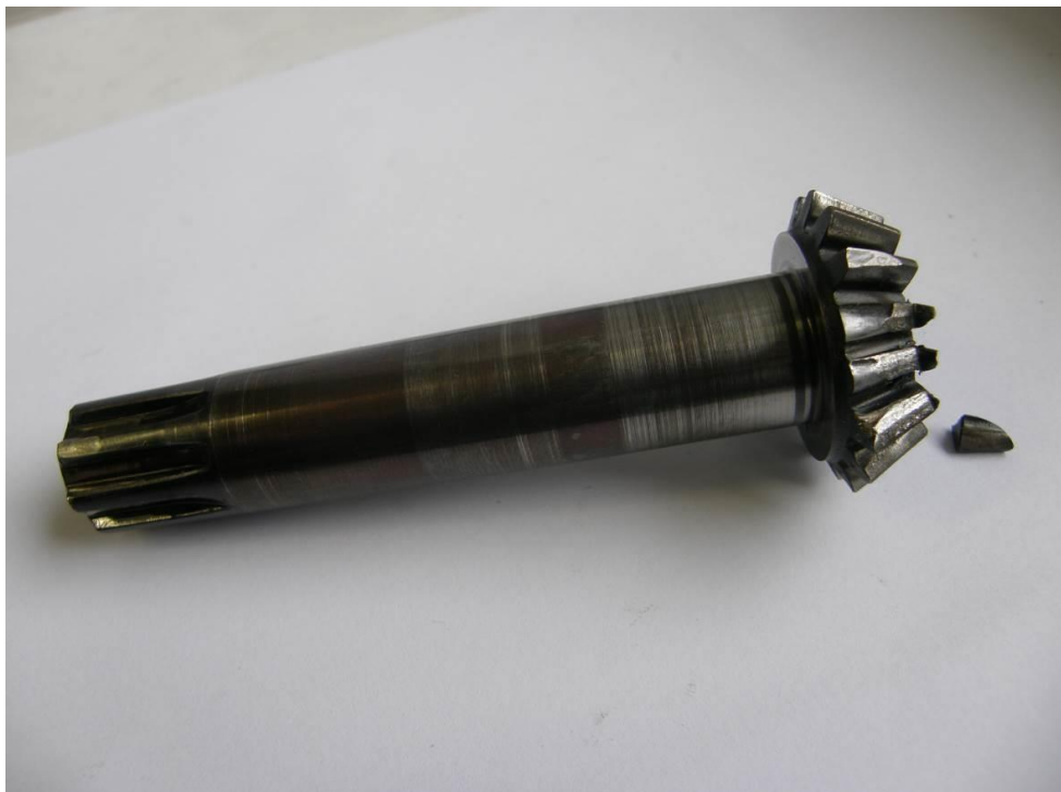
Obr. 4 – Poškozené kolo p/n Sc 3755 s ulomeným zubem.
