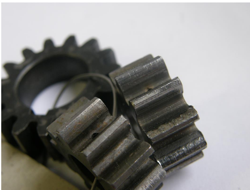
Obr. 7 – Porovnání kola 1400 hod vlevo a poškozeného kola neznámého původu vpravo.
