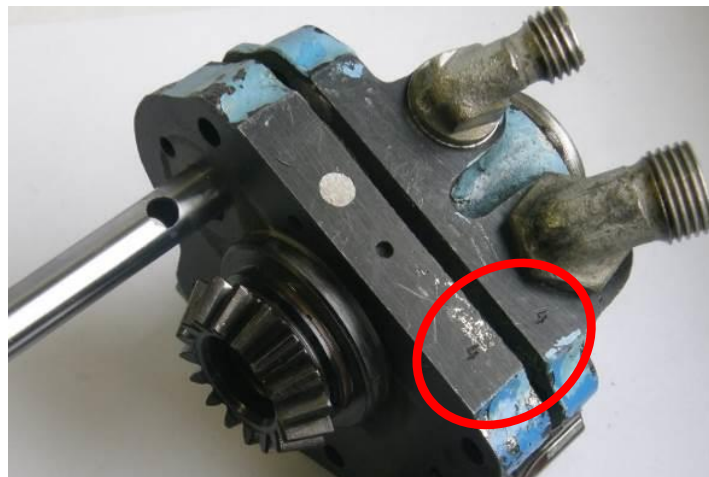
Obr. 1 – Předmětné poškozené vratné olejové čerpadlo vačkové skříně sestava č. 4.
