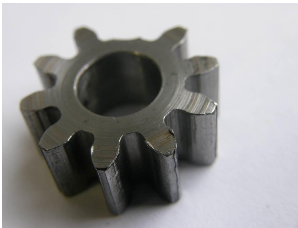
Obr. 2 – Vratné olejové čerpadlo vačkové skříně M137AZ s opotřebenými zuby a obroušenou hranou komory, zelené šipky značí směr otáčení ozubených kol, modrá šipka obroušenou hranu komory od otřepů kola.
