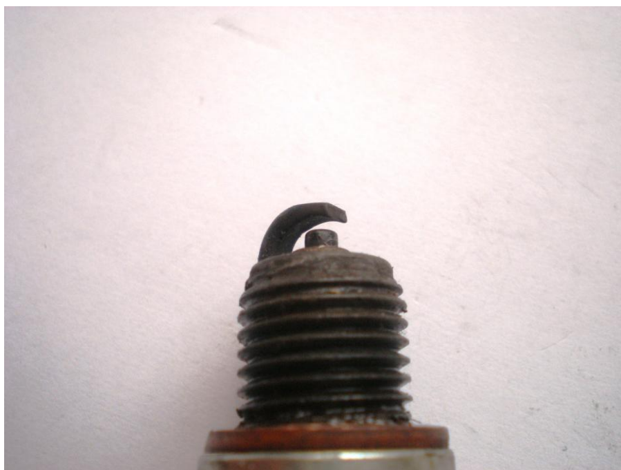
Obr. 2 - použitá svíčka vizuálně vyhodnocená jako dobrá před seřízením elektrod
