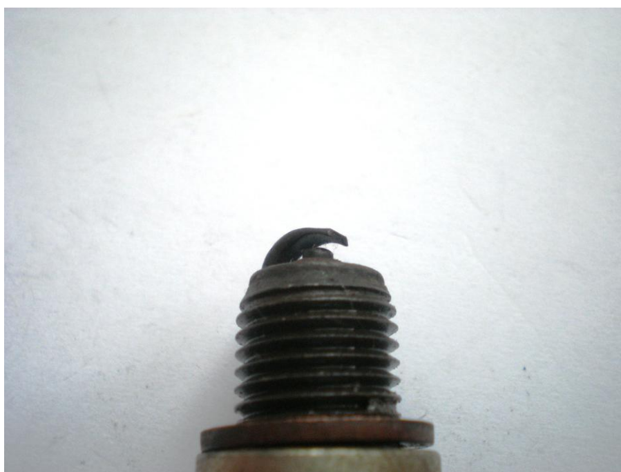
Obr. 3 - použitá svíčka vizuálně vyhodnocená jako opotřebená
